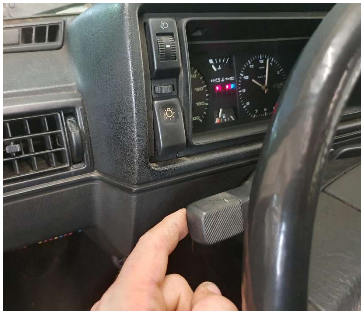
Abb. 15: Überprüfung des Fernlichts auf einwandfreie Funktion
