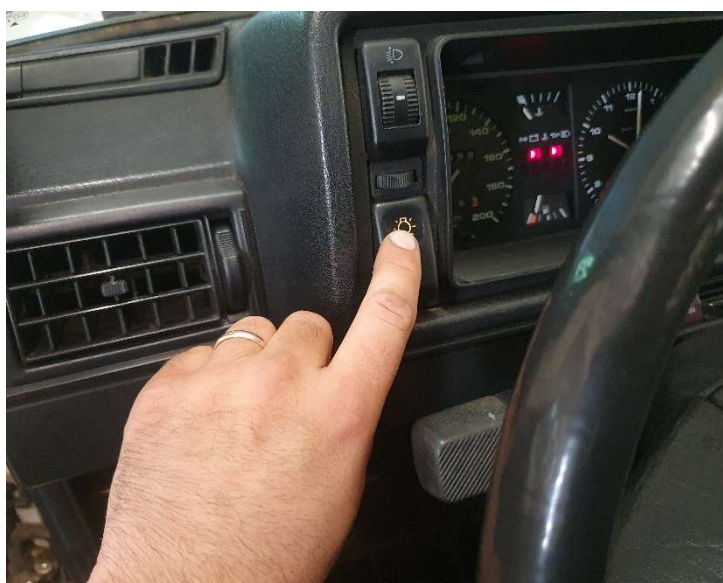
Abb. 14: Überprüfung des Abblendlichts auf einwandfreie Funktion
