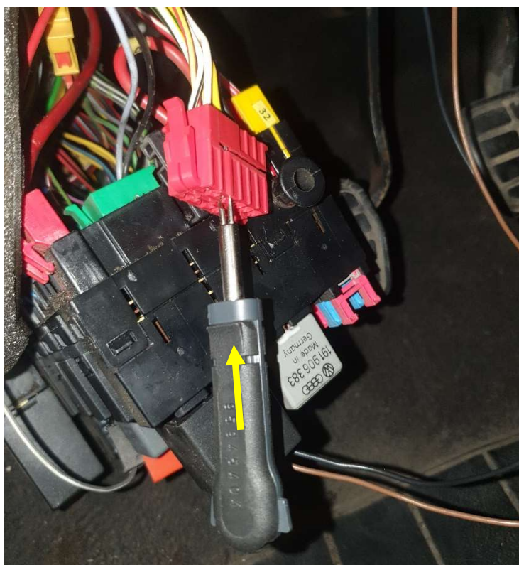
Abb. 5: Auspinnen des Flachsteckkontakts J/3
