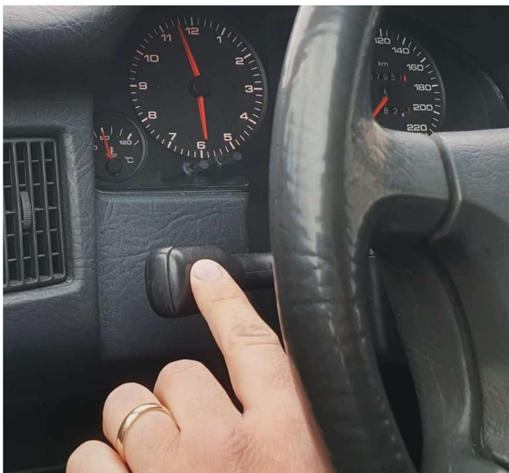
Abb. 18: Überprüfung des Fernlichts auf einwandfreie Funktion
