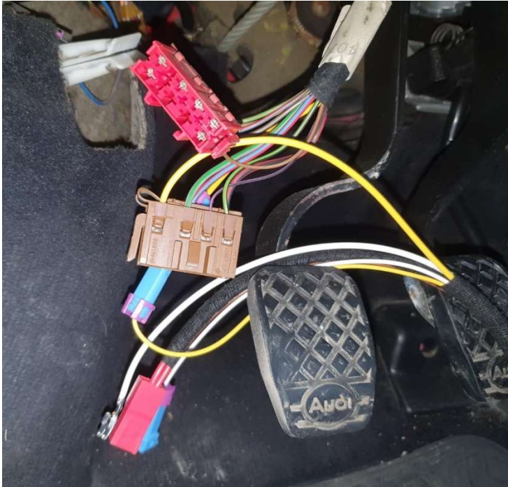
Abb. 9: Gelbes Kabel des Entlastungsmoduls im braunen Stecker
