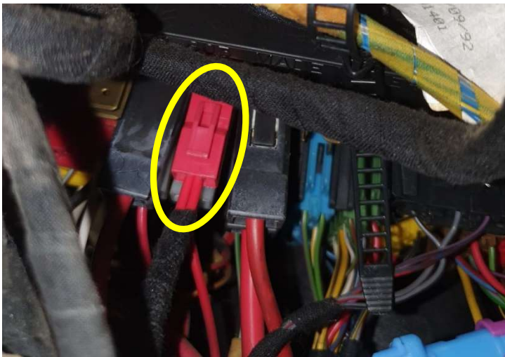
Abb. 13: Plusversorgung am Steckfeld L angesteckt
