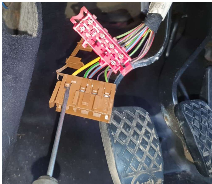
Abb. 6: Ausspinnen des Steckkontakts (Abblendlicht – 56b)
