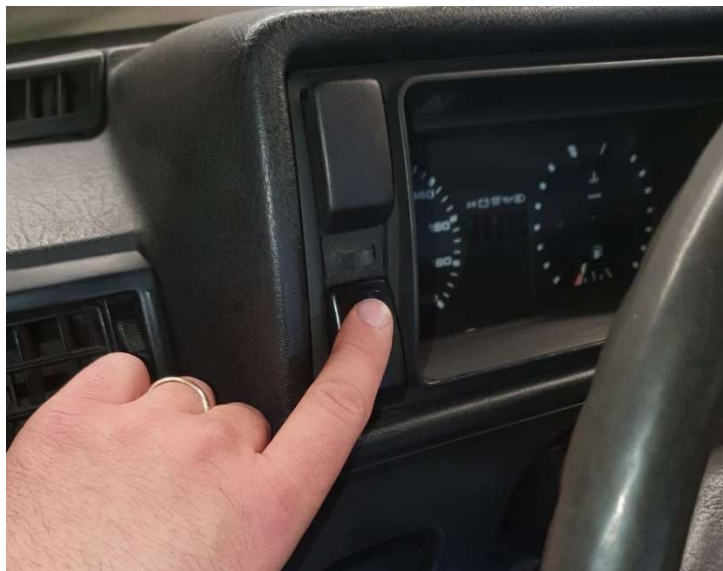
Abb. 14: Überprüfung des Abblendlichts auf einwandfreie Funktion
