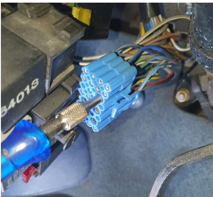
Abb. 3: Auspinnen des Rundsteckkontakts A21 am blauen Stecker
