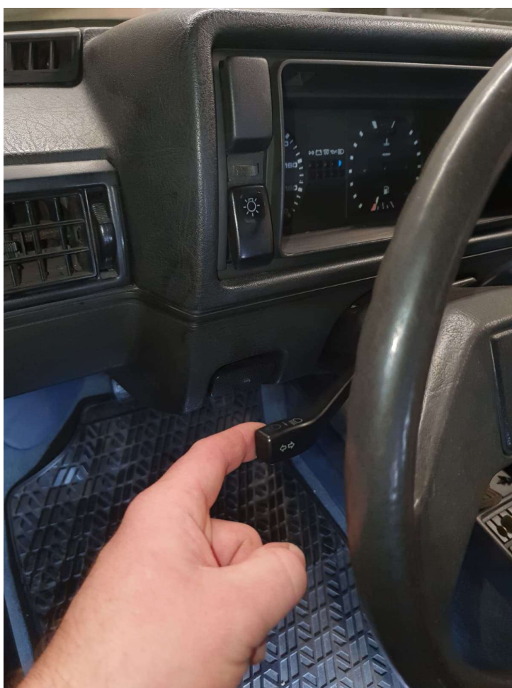
Abb. 15: Überprüfung des Fernlichts auf einwandfreie Funktion
