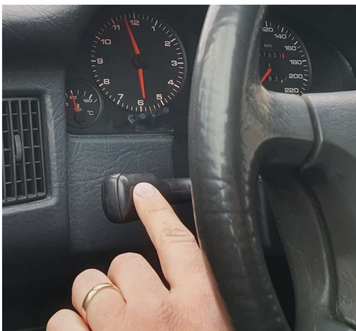
Abb. 18: Überprüfung des Fernlichts auf einwandfreie Funktion
