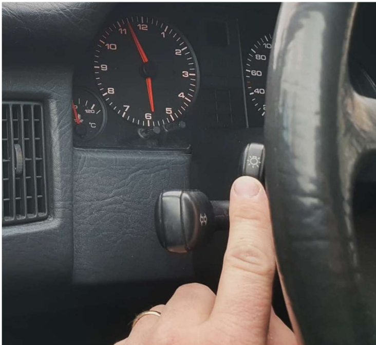
Abb. 17: Überprüfung des Ablendlichts auf einwandfreie Funktion
