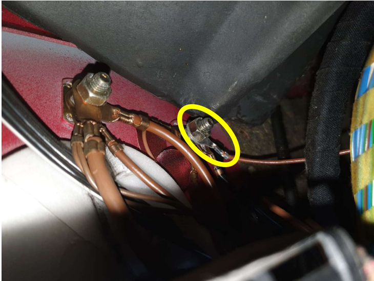
Abb. 14: Massekabel am Massepunkt angeschlossen
